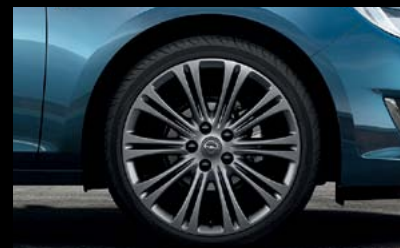
Lichtmetalen velg, 8 J x 19, multispakaas, titanium, bandenmaat 235/40 R 19 (PZU). 8
