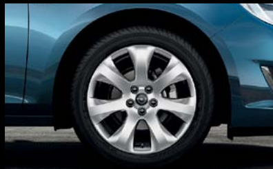
Lichtmetalen velg, 7 J x 17, 7 spaken, banden maat 215 (225)/50 R 17 (RCN). 2
