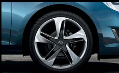
Lichtmetalen velg, 8 J x 19, 5 spaken, bandenmaat 235/40 R 19 (Q1D). 8
