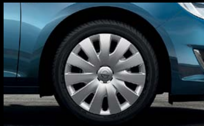
Stalen velg met wioldop, 6,5 J x 16, bandenmaat 205 (215)/60 R 16 (PWM & NQ1). 1
