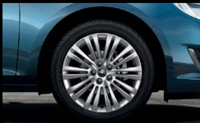
Lichtmetalen velg, 7 J x 17, multispakaas, zilverkleurig gelakt, bandenmaat 215 (225)/50 R 17 (PXS). 4
