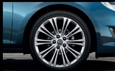
Lichtmetalen velg, 8 J x 19, multispakaas, bandenmaat 235/40 R 19 (RV4). 8
