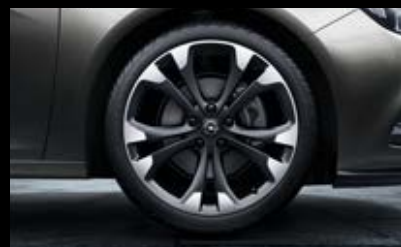
Lichtmetalen velg, 8,5J x 20, 5 dubbele spaken, bi-colour, bandenmaat 245/40 R 20 (RTH). 1
