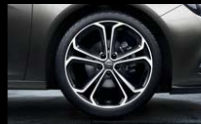
Lichtmetalen velg, 8,5J x 20, 5 dubbele spaken, bi-colour, bandenmaat 245/40 R 20 (ROA). 1,3
