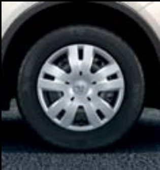
16-inch stalen velg. 6,5 J x 16, bandenmaat 205/70 R 16. (RRY, standaard op Selection.)
