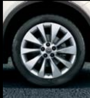
18-inch 10-spaaks lichtmetalen velg, Sterling Silver. 7 J x 18, bandenmaat 215/55 R 18. (RV8, standaard op Innovation.)
